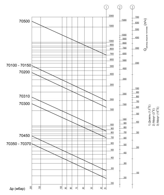
Расход, показанный на шкале № 1, относящейся к вязкости 1,5°E (дизельное топливо), был получен с использованием фильтрующих элементов со степенью фильтрации 0,1 мм (100 µм).
